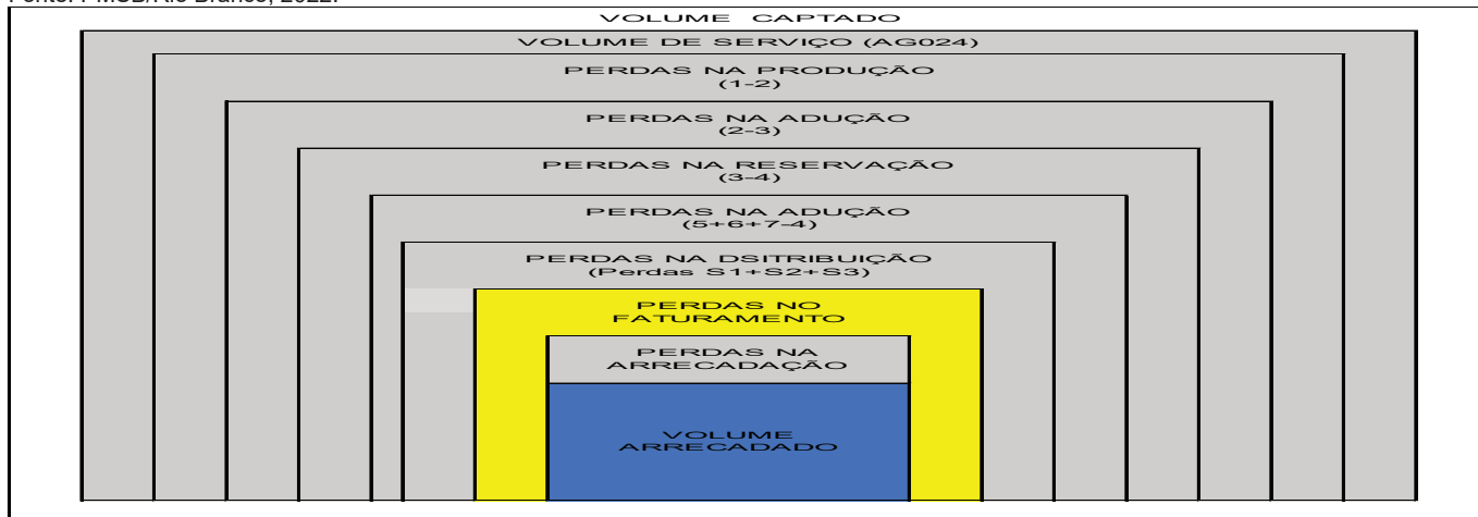
Figura 12 – Esquemática das perdas aparentes no sistema.
